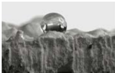
Kvapka vody na hydrofóbnom povrchu štandardnej omietky
