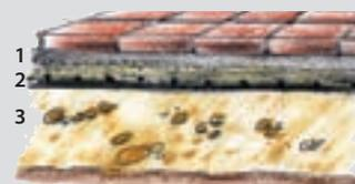
Verlegung im Mörtelbett – 1 Mörtel, 2 Unterlagsbeton mit Baustahlgitter, 3 ungebundene untere Tragschicht
