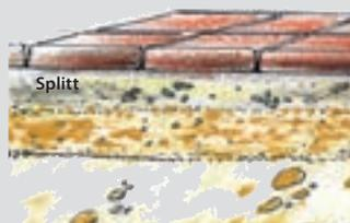
färbenden Gummihammer abgeklopft (keine Rüttelplatte verwenden) und nochmals mit dem selben Fugensand eingekehrt bis die Fugen völlig ausgefüllt sind. Beim Verlegen von Großformatplatten ist bereits während der Verlegung auf ein gleichmäßiges Oberflächenniveau zu achten (siehe Richtlinie Großformatplatten FQP). Ein späterer Ausgleich durch Rütteln ist nicht mehr möglich.
