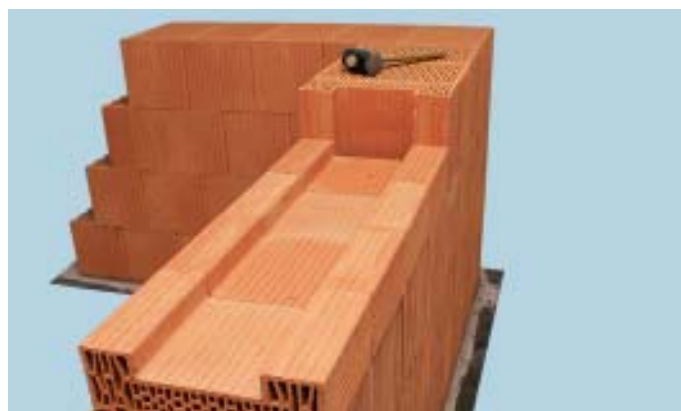
Parapet a začiatok ostenia vytvorený z koncových polovičných tehál
